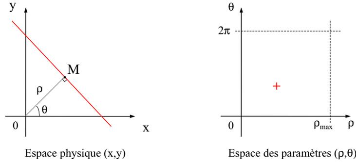
FIG. B.1 – Description biunivoque d'une droite par son inclinaison  $\theta$  et sa distance au centre du repère  $\rho$ .
