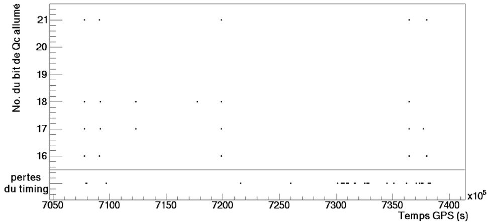
FIG. 3.7 – Incidents GPS et perte des données du système de synchronisation.
