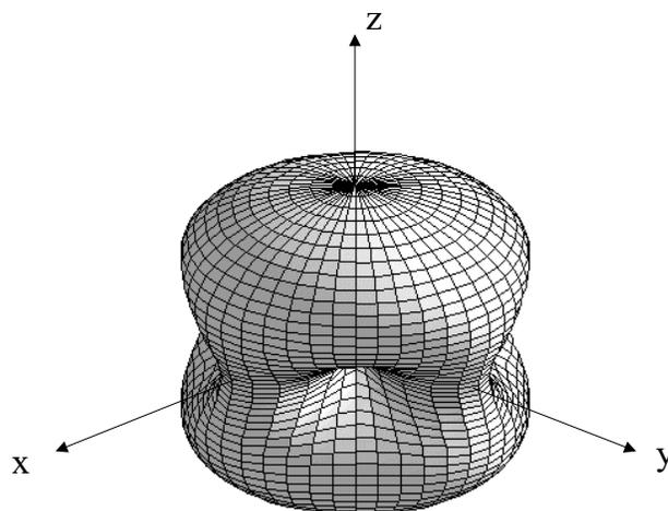
FIG. 2.2 – Sensibilité d'un interféromètre en fonction de la direction d'incidence d'une onde gravitationnelle non polarisée (les bras de l'interféromètre sont confondus avec les axes  $(Ox)$  et  $(Oy)$ ) [33].
