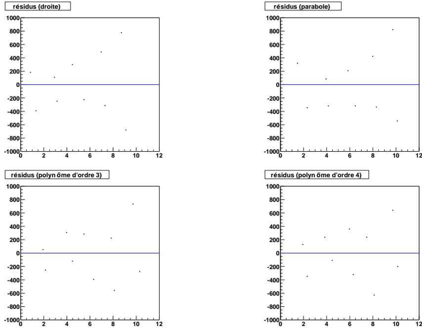
FIG. 3.5 – Résidus après ajustement par des fonctions polynomiales de différents ordres .
