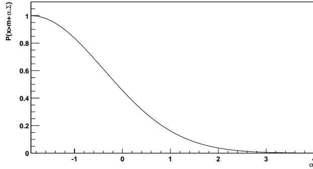
FIG. A.3 – Probabilité pour qu'une grandeur  $x$  suivant la loi (A.7) soit supérieure à une valeur  $X$ .
