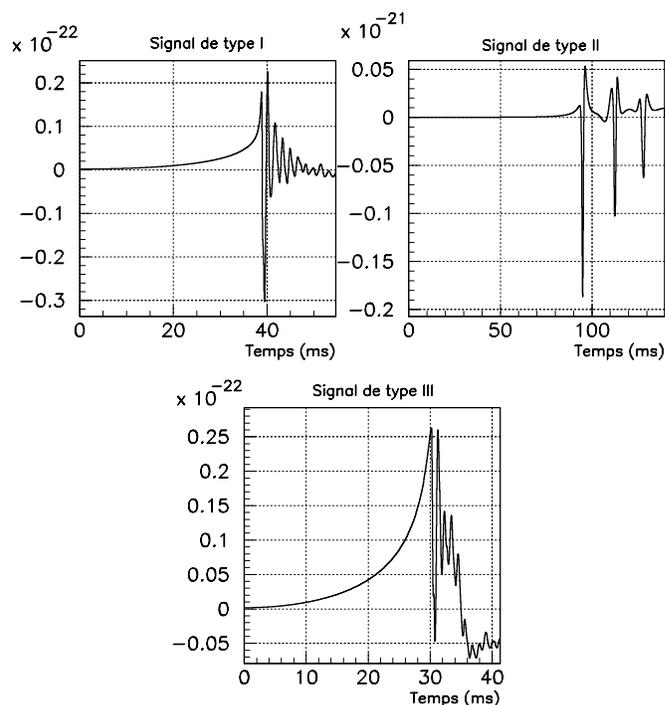
FIG. 1.5 – Formes d'ondes gravitationnelles émises lors d'une supernova, prédites par Zwerger et Müller [19].
