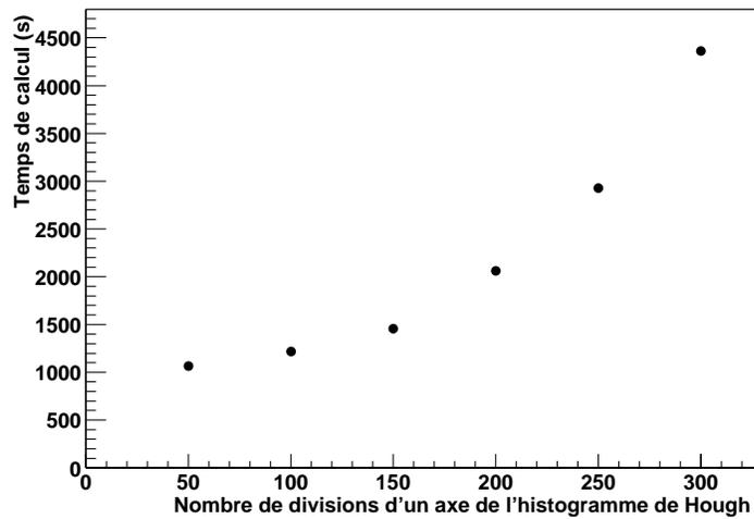
FIG. 7.3 – Temps de calcul pour 100 valeurs successives de  $f_o$  en fonction du nombre de divisions des axes de l’histogramme de Hough.
