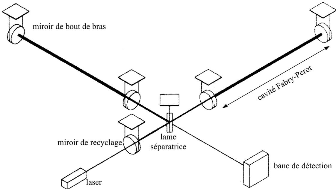
FIG. 2.1 – Schéma de principe de Virgo.
