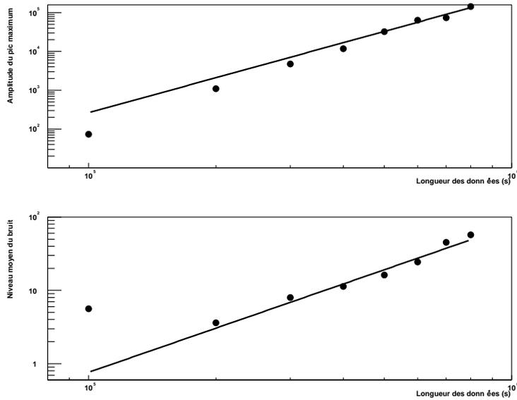
FIG. 7.4 – Variation de la hauteur du pic maximum et la variation de la valeur moyenne du bruit en fonction de la longueur des données disponibles.
