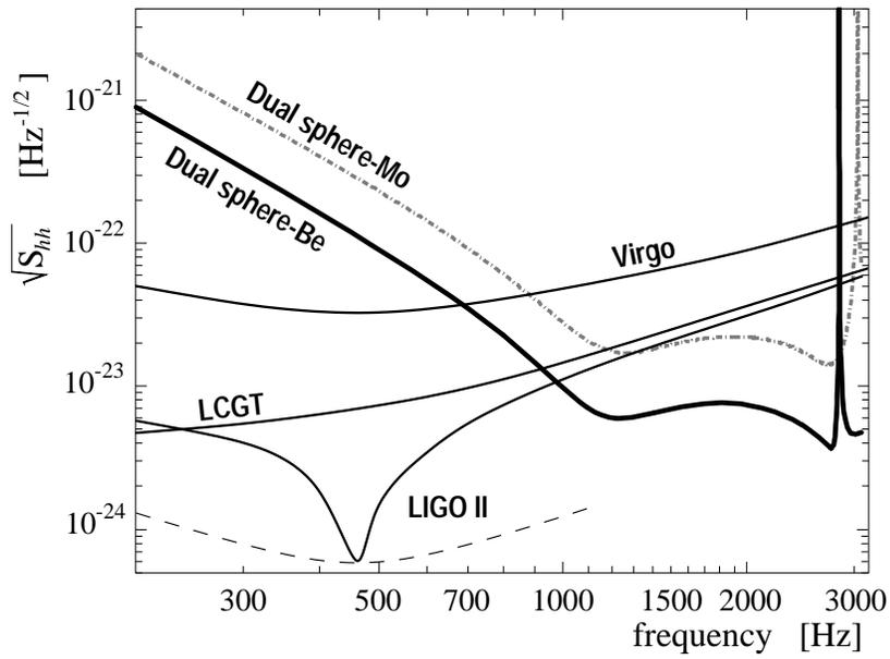
FIG. 2.7 – Courbe de sensibilité d’une sphère imbriquée dans une couronne sphérique [52].
