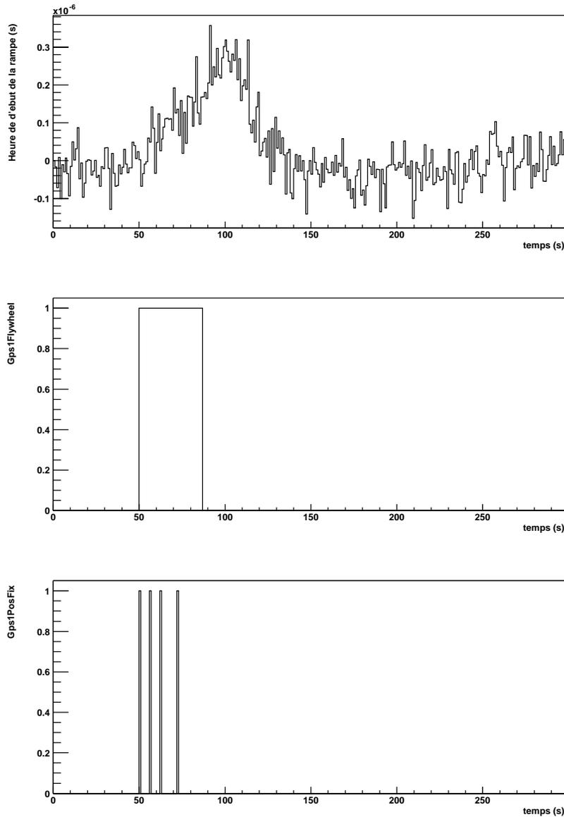
FIG. 3.10 – Exemple d'un dysfonctionnement de l'horloge GPS.
