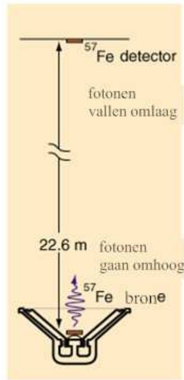
Figuur 3: Schematische weergave van het Pound-Rebka-Snider experiment voor de meting van de gravitationele roodverschuiving van fotonen door de aarde.
