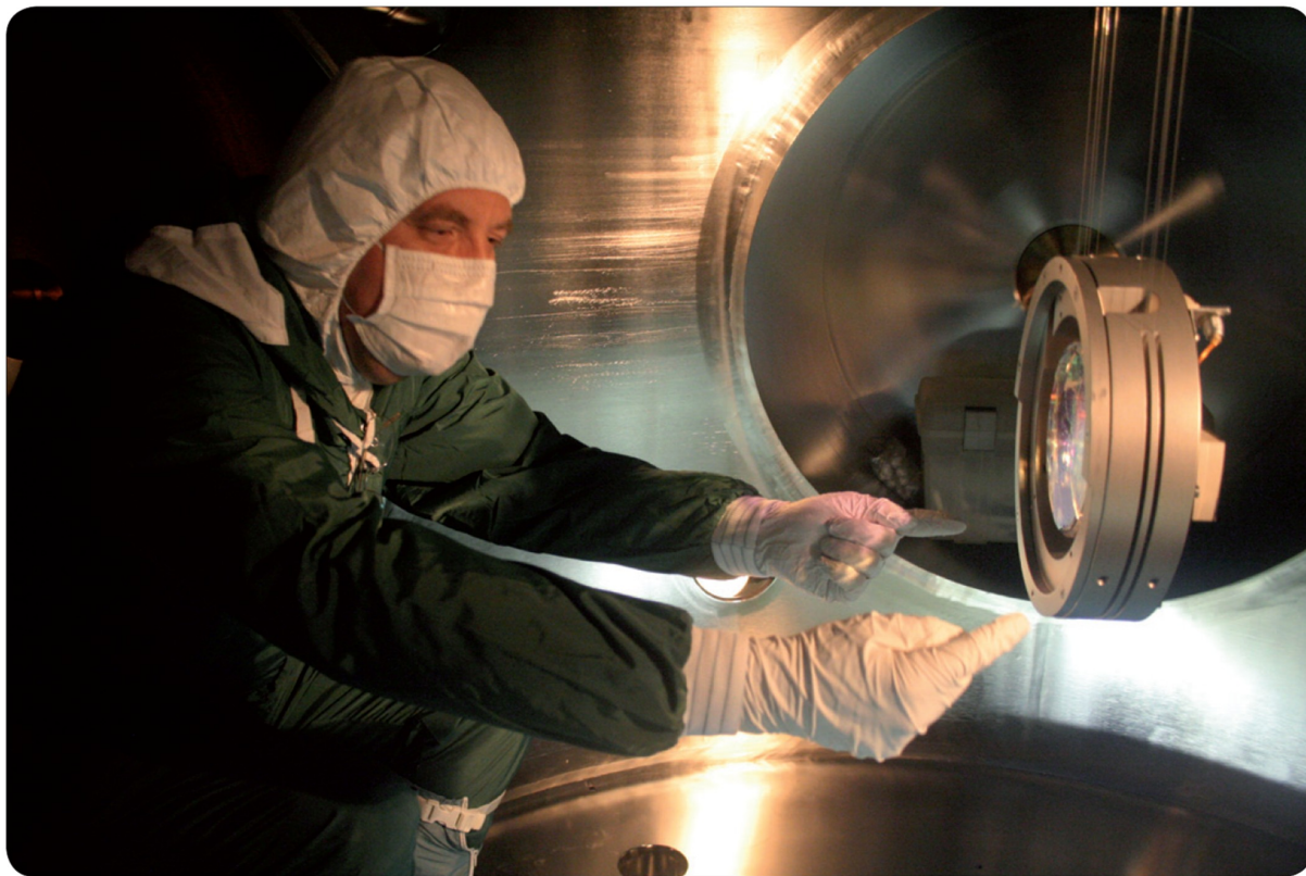
Figure 3: Eindspiegel van de input-mode cleaner van Virgo. De figuur toont de nieuwe spiegel en reactiemassa die ontworpen en geconstrueerd is door Nikhef. De spiegel bevat magneetjes en wordt met spoelen in de reactiemassa gepositioneerd. Spiegel en massa zijn opgehangen met draden aan een zogenaamde Marionette. Bron: Bruno van Wayenburg, NRC, July 2008.
