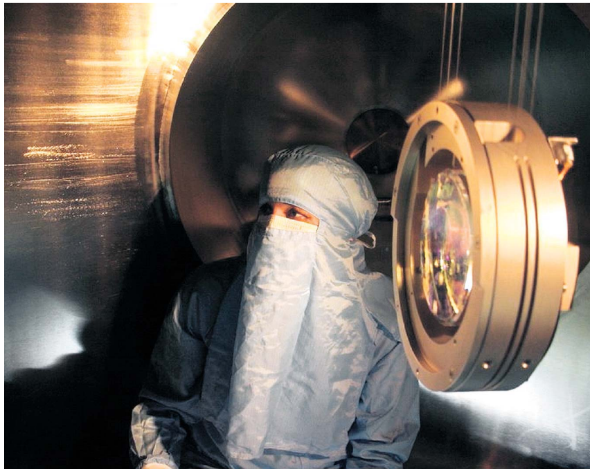
• Een onderzoeker in boerka-achtig cleanroompak bij de nieuwe spiegel voor de Input Mode Cleaner, het eerste Nederlandse onderdeel van virgo. Hierboven: een van de drie kilometer lange armen van de proefopstelling, van buiten en van binnen (de binnenste buis wordt vacuüm gezogen).
