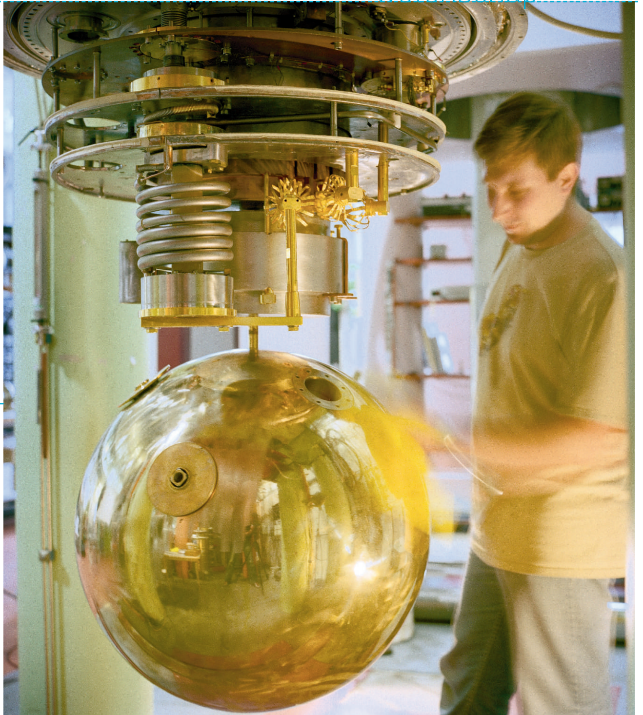
De Leidse MiniGrail: 's werelds eerste bolvormige antenne voor het detecteren van zwaartekrachtgolven
