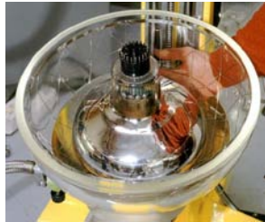
10" PMT licht detectie
